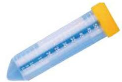
Los tubos de centrifuga sirven para contener muestras y ser separadas mediante centrifugación. Permiten separar partículas sólidas de líquidos, así como plasma y glóbulos. GenFollower utiliza polipropileno siendo un material excepcionalmente resistente a los productos químicos, en presentación de tubo cónico de 50 ml para centrifuga.
