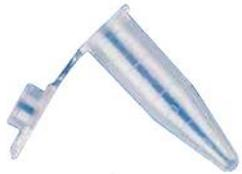
Los tubos de microcentrífuga son útiles para almacenar las muestras (suspensiones y líquidos inmiscibles) que se van a aislar y separar mediante una microcentrífuga. Por lo general, estos tubos pueden manejar pequeños volúmenes de muestra, en presentación de tubo cónico de 1.5 mL para microcentrífuga, color natural.
